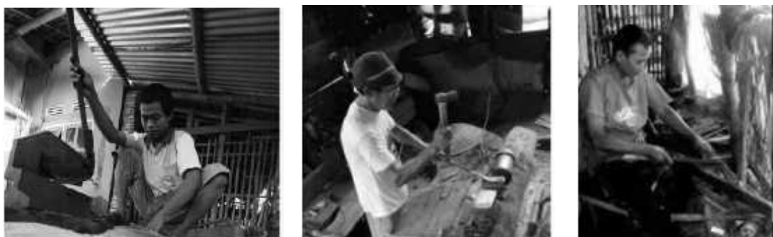
Gambar 3. Proses pemotongan, penipisan, dan penajaman plat stainless steel menjadi bilah pisau secara manual.
