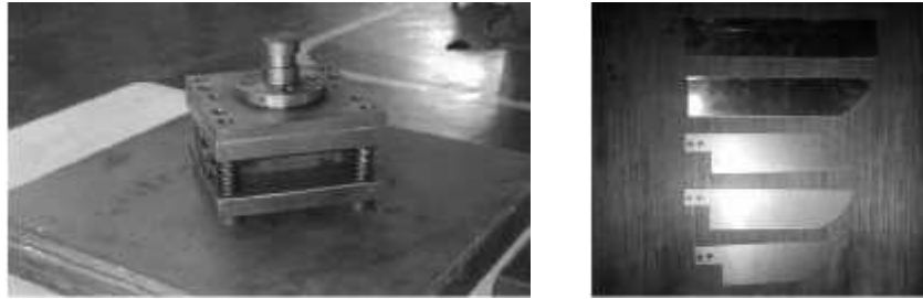
Gambar 5. Unit peralatan press tool pembuat bilah pisau stainless steel ukuran besar dan produk bilah pisau ( Zani et al, [3] )
